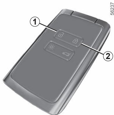
Když je vozidlo vybaveno dvojitým zamykáním, umožňuje zamknout otevíratelné části a zamezit otevření dveří vnitřními rukojeťmi (v případě rozbití skla a následného pokusu o otevření dveří zevnitř).
