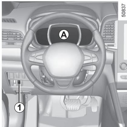
**Přístrojová deska A:** při otevření dveří řidiče se rozsvítí. Při zapnutí zapalování otáčením kolečka **1** nastavte intenzitu jasu přístrojové desky.
