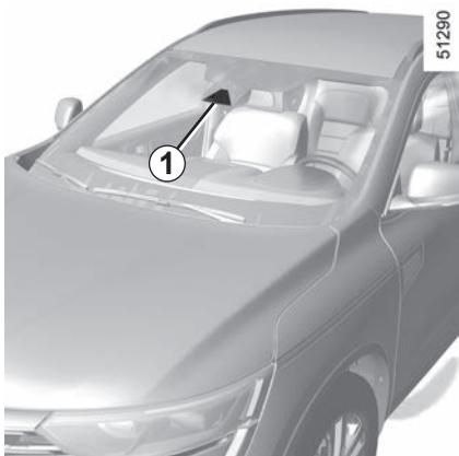
Na základě údajů z radaru **1** upozorní tato funkce řidiče na časový odstup, který ho dělí od vozidla před ním. Řidič tak může udržovat bezpečnou brzdovou vzdálenost mezi vozidly.
