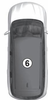
Pokud při **spuštěném motoru** není po otevření a zavření dveří karta nadále v oblasti 6, zpráva „Karta nedetekována“ Vás upozorní, že karta už není ve vozidle. Tím se zamezí např. odjetí po vysazení spolujezdce, který bude mít kartu u sebe.
