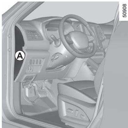
Při výpadku některého elektrického zařízení zkontrolujte stav pojistek.
