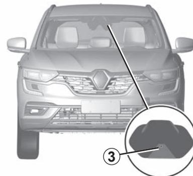
Systém **B** používá radarový a kamerový snímač **3**.
